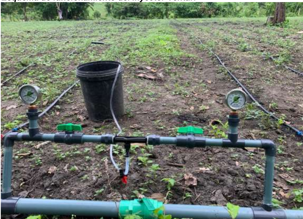
Figura 28. Esquema de funcionamiento del Inyector Venturi
